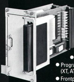
Messdaten-Analysator zur permanenten Überwachung von Netzwerken in allen Industriezweigen.
