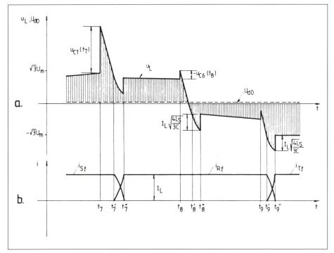
**Bild 3** Spannungs- und Stromverläufe bei den Umschaltvorgängen Bezeichnungen: siehe Bilder 1 und 2
