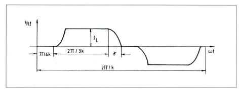
Bild 5 Verlauf des Phasenstromes  $i_{Rf}$
