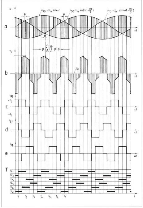
Bild 2 Funktionsprinzip des aktiven Leistungsfilters
