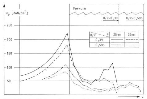
Figure 4 Evolution axiale des contraintres  $\sigma_z$  dans un isolateur
