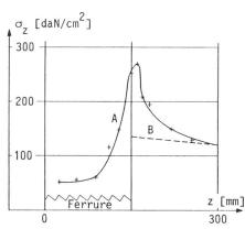
Figure 5 Calcul des contraintes  $\sigma_z$  en flexion Comparaison des contraintes  $\sigma_z$  calculées par RDM et par Ansys
