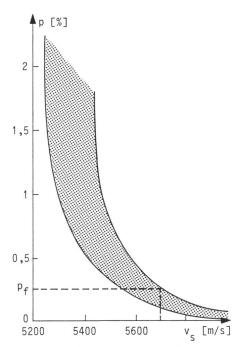
Figure 10 Relation entre porosité et vitesse ultrasonore
