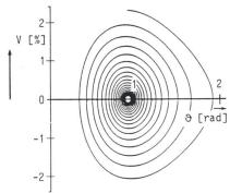
Bild 6 Dämpfung durch Steuerung der Antriebsleistung mittels linearem Regler
