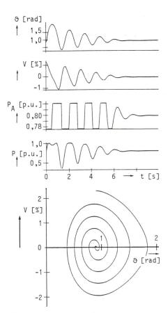
Bild 7 Dämpfung durch Steuerung der Antriebsleistung mittels dämpfungsoptimalem Regler
