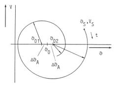
Bild 5 Trajektorien  $V(\theta)$  bei dämpfungsoptimaler Umschaltung der Antriebsleistung. Durch Umschalten zwischen  $\vartheta_{01}$  und  $\vartheta_{02}$  lässt sich die Winkelamplitude während einer Periode um  $4 \cdot \Delta \vartheta$  verringern.
