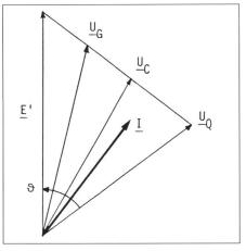
Bild 3 Zeigerdiagramm für den stationären Betriebspunkt
