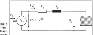
Ersatznetz bei Wirkund Blindleistungssteuerung
