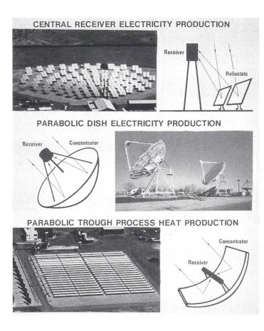
Bild 2 Die verschiedenen Solarkraftwerkstypen
