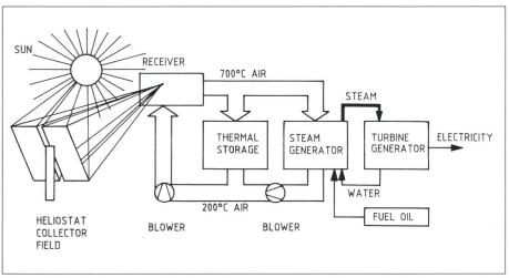
Bild 1 Flussdiagramm eines Solarkraftwerkes
