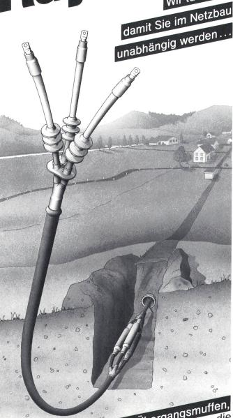
... mit unseren Übergangsmuffen, Verbindungsmuffen und Endverschlüssen, die einfach und schnell zu montieren sind. Wir garantieren Sicherheit und lange Lebensdauer.
