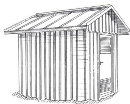
Trafo-Stationen mit Giebeldach
