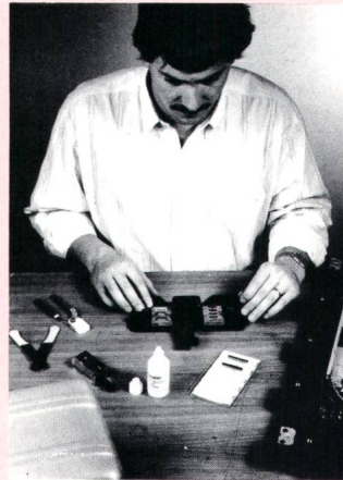
Arbeit mit dem Fibrlok-Spleiss
