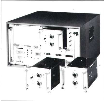
Bild 8 Kombinations-Wellengenerator (Combination Wave Generator) mit modularen Einschüben für verschiedene Impulsformen
