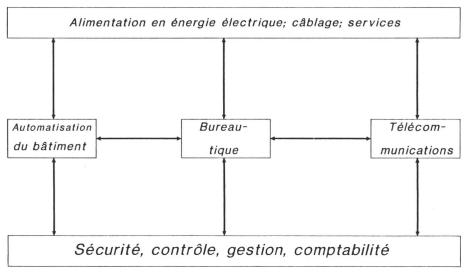
Figure 1 Diagramme-bloc d'un bâtiment intelligent
