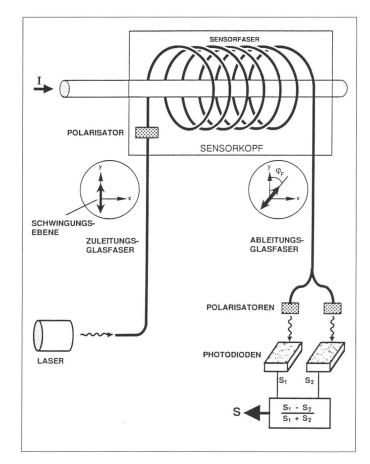
Bild 6 Prinzipschema eines faseroptischen Stromsensors mit polarimetrischer Detektion
