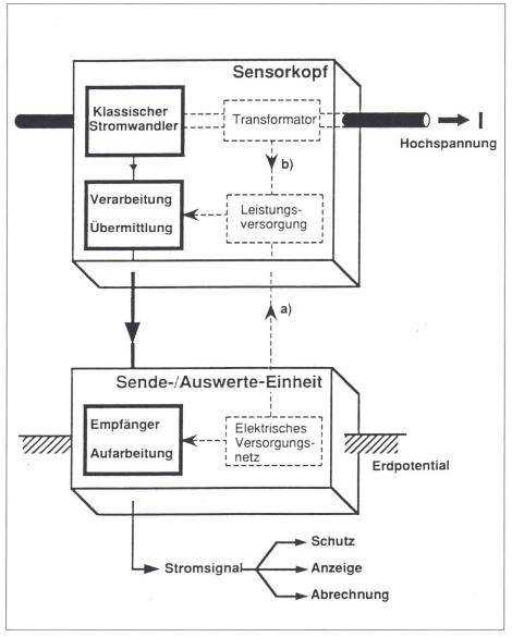
Bild 3 Prinzipschema eines nichtkonventionellen Stromwandlers
