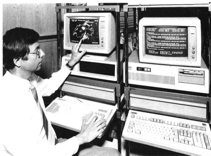
Messausrüstung zur Blitzortung und Blitzparameter-Bestimmung der PTT
