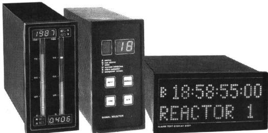
Ein mikroprozessorgesteuerter **Zweikanal-Leuchtband- und Digitalanzeiger** 72 x 144 mm für alle elektrisch messbaren Prozessgrößen einschließlich Thermoelemente und Pt 100 Sonden. Messkreise galvanisch getrennt. Pro Kanal können 2 Grenzwerte gesetzt werden. Alle Parameter sind mittels 3 Tasten konfigurierbar.
