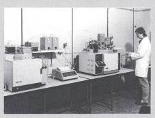
Gaschromatograph für die Gasanalyse von Isolieröl
