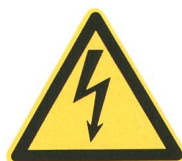
gefährliche elektrische Spannung
