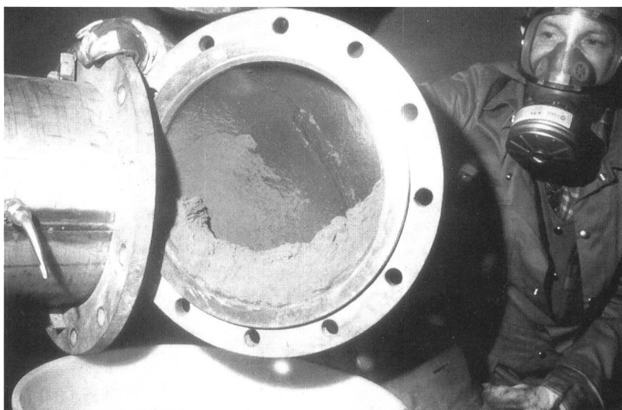
Bild 5 Im unvollendet gebliebenen Kernkraftwerk Marviken, Schweden, wurden Aerosol-Freisetzungsversuche aus Reaktorbauteilen voller Grösse – Reaktordruckbehälter und Druckhalter – angestellt. 16 Organisationen aus Europa, Nordamerika und Asien beteiligten sich an den Kosten von insgesamt 30 Millionen US-Dollar. Die Versuche mit nicht radioaktivem Jod, Cäsium und Tellur haben u.a. gezeigt, dass sich in der Rohrleitung zur Druckentlastung des Reaktordruckbehälters grosse Mengen Aerosole ablagern.
