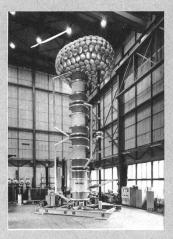
Haefely baut zur Zeit zwei Baureihen: eine in modularer Bauweise bis zu höchsten Spannungen und Strömen und eine in Kesselbauweise für Spannungen bis zu 450 kV. Alle Anlagen werden standardmässig mit einem rechnerunterstützten, dialogfähigen Steuersystem ausgerüstet.
