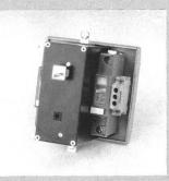
schutz, Längsentkopplung und Feinschutz, welche einen Spannungsabfall verursachen und den Wirkungsgrad einer Anlage beeinträchtigen. Ein typischer Anwendungsfall von Üssa ist der Überspannungsschutz von Ladereglern von Solarmodulen.
