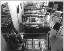
Herstellung von Leiterplatten in Siebdruck-Technik
