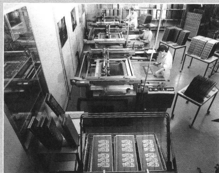
Herstellung von Leiterplatten in Siebdruck-Technik
