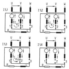
Bild 7 Ersatzschaltbilder der Teilintervalle aus Bild 6
