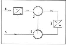
Bild 1 Prinzipschema einer bürstenlosen Erregungseinrichtung mit Gegendrehfeld-Erregermaschine
