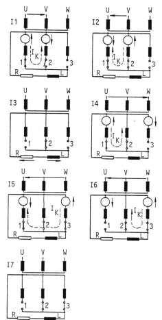
Bild 5 Ersatzschaltbilder für verschiedene Teilintervalle
