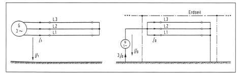
Bild 5 Mit- und Nullimpedanzmessung einer symmetrischen Leitung (z.B. Freileitung)
