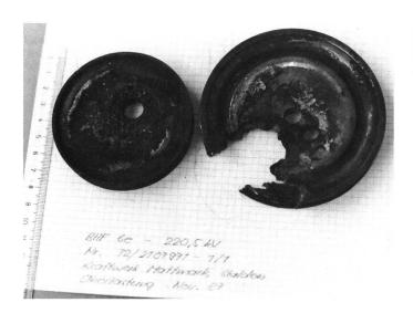
Bild 2 Schadensbild 220-kV-Funkenstrekkenableiter
