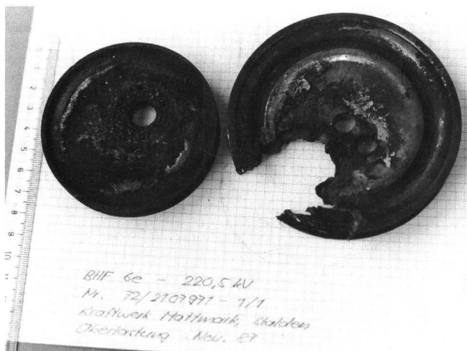
Bild 2 Schadensbild 220-kV-Funkenstrecken- ableiter
