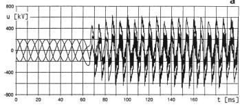
Bild 7 Phasenspannungen der 90-MVA-Transformatorbank (unbeeinflusst) bei unterschiedlichen Netzparametern
