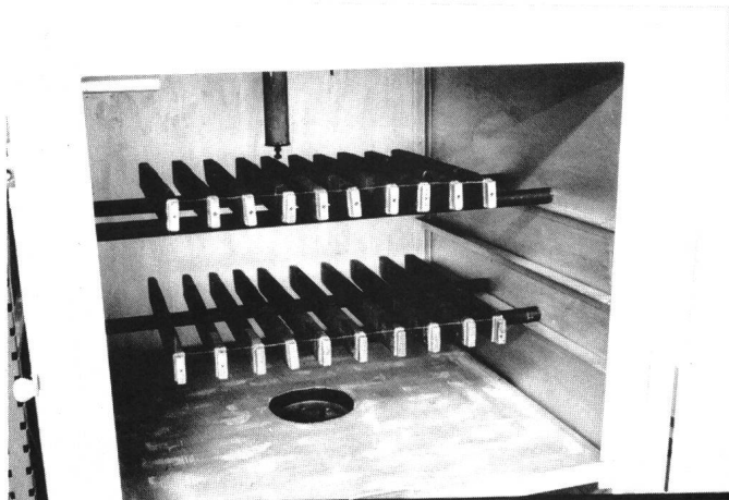
Bild 4 Alterungsöfen, mit 20 Normprüflingen bestückt
