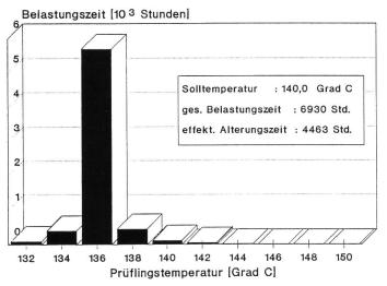
Therm. Belastungshistogramm Prüfling B
