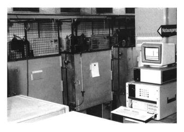
Bild 1 Umluftöfen mit Hochspannungseinrichtung für 0...20 kV
