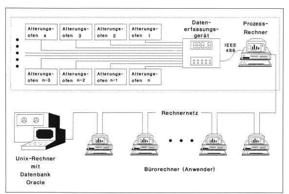
Prinzipschaltbild der EDV-Anlage für das Alterungslabor
