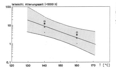
Bild 6 Experimentell bestimmte Lebensdauerkurven einer Stator-Wicklungsisolierung
