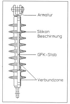
Bild 1 Bauweise und Komponenten von Verbundisolatoren
