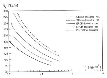
Bild 13 Überschlagswechselspannung in Abhängigkeit vom Salzgehalt für verschiedene Isolatorenmaterialien
