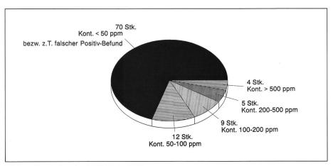
Bild 1 Ergebnisse der PCB-Tests 1989
