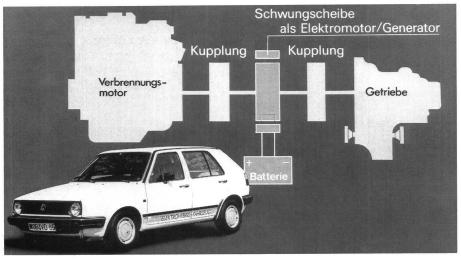
Bild 1 Die Anordnung des Dieselmotors und des Elektromotors in einem VW-Hybrid-Golf
