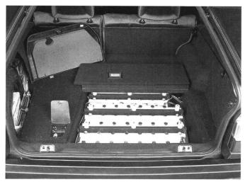
Bild 3 Die NiCd-Hochleistungsbatterie des Audi duo in der Reserveradmulde unter dem Gepäckraum
