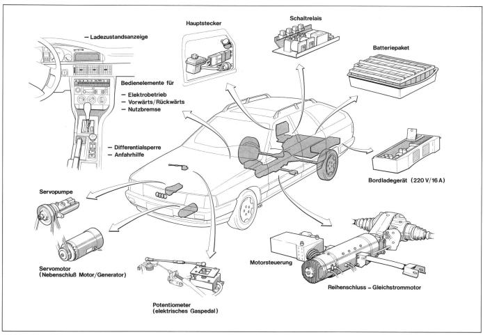
Bild 1 Die wichtigsten Elektroantriebskomponenten des Audi duo
