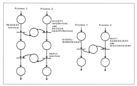
Bild 6 Synchrone und asynchrone Kommunikationsmechanismen des Betriebssystems
