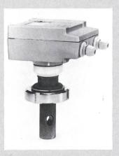
Die neue Leitfähigkeitsmessung arbeitet kontaktlos.
