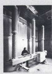
Prüfung von SF6-Blaskolbenschaltern bei arktischen Temperaturen
