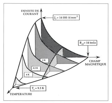
Figure 1 Surface critique d'un supraconducteur
