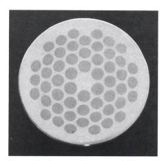
Figure 2 Supraconducteur multifilamentaire en NbTi
