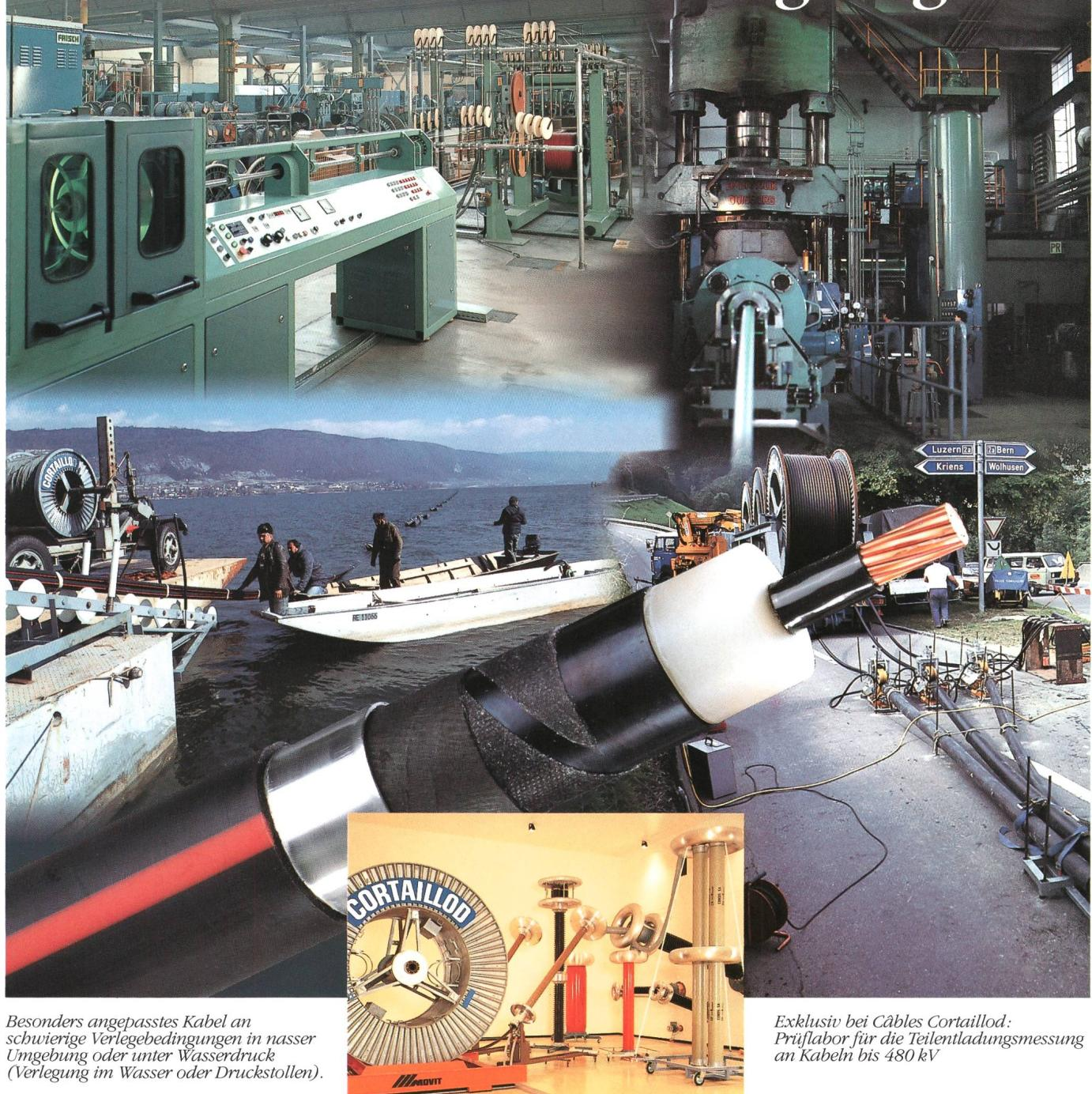
Besonders angepasstes Kabel an schwierige Verlegebedingungen in nasser Umgebung oder unter Wasserdruck (Verlegung im Wasser oder Druckstollen).
