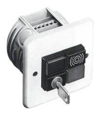
Unsere Meldeleuchten, Leuchtdrucktasten, Schlüsselschalter, Alarmgeber der Baureihe 31 und 51 lassen sich bestens in Universal-Einlasskasten (Typ NIS, Grösse I) einbauen. Das sieht nicht nur gut aus, es geht auch schnell: die Schalter werden auf der speziellen Abdeckplatte montiert, so dass es zum Einbau weder Bohrer noch Dübel braucht. Auf Wunsch ist die Verdrahtung bereits auf Anschlussklemmen geführt.
