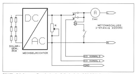
Bild 22 Schaltung zur Provokation des Selbstlaufs des SOLCON. R wurde so gewählt, dass minimaler Strom  $I_{ac}$  fliesst:  $R=130~\Omega \rightarrow I_{ac}=1,80~A$  bei  $P_{ac}\approx 420~W$ .
