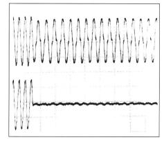
Bild 11 Selbstlauf des SI-3000 bei Pac = 420 W und angepasster Last in der Schaltung nach Bild 10. Oben: Oszillogramm der Ausgangsspannung des SI-3000. Unten: Gleichzeitig abgeschaltete Netzspannung. Vertikal: 200 V/div. Horizontal: 50 ms/div.
