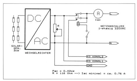
Bild 10 Schaltung zur Provokation des Selbstlaufs des SI-3000.
