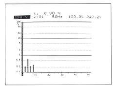
Bild 17 Spektrum der Oberschwingungsspannungen am Anschlusspunkt des SOL-CON; eingespeiste Leistung  $P_{ac} = 2,3 \text{ kW}$ .
