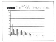
Bild 19 Spektrum der Oberschwingungsströme des SOLCON bis zur 50. Harmonischen (2,5 kHz); eingespeiste Leistung  $P_{ac}$  = 2,3 kW.
