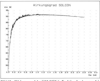
Bild 15 Wirkungsgrad des SOLCON in Funktion der Ausgangsleistung  $P_{ac}$ .
