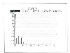
Bild 18 Spektrum der Oberschwingungsspannungen am Anschlusspunkt des SOL-CON; eingespeiste Leistung  $P_{ac} = 0$ .
