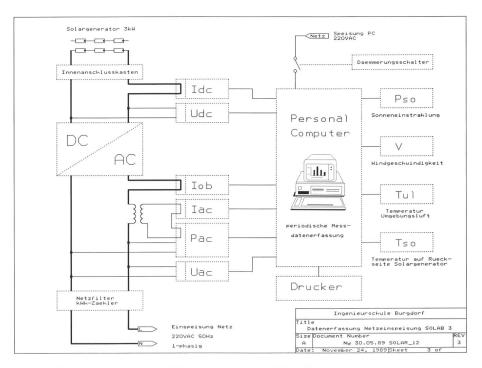
Bild 1 Blockschema der 3-kW-Photovoltaikanlage SOLAB 3.
