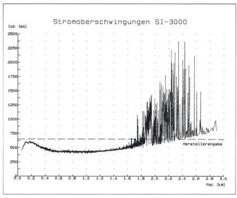
Bild 3 Stromoberschwingungen  $I_{ob}$  in Funktion der Ausgangsleistung  $P_{ac}\, vor\, Modifikation.$
