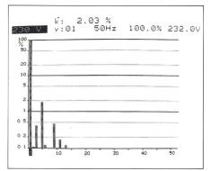
$\begin{array}{lll} Bild\ 7 & Spektrum & der & Oberschwingungsspannungen & am & Anschlusspunkt & des \\ SI-3000\ ; eingespeiste \ Leistung\ P_{ac} = 0. \end{array}$
