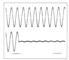
Bild 23 Selbstlauf des SOLCON bei  $P_{ac}=420~W$  und angepasster Last in der Schaltung nach Bild 22. Oben: Oszillogramm der Ausgangsspannung. Unten: Gleichzeitig abgeschaltete Netzspannung. Vertikal: 200 V/div. Horizontal: 20 ms/div.
