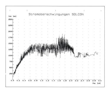
schwingungen (siehe Bild 17 und 18) ist deutlich ersichtlich, dass der Wechselrichter vor allem die 3., 9. und 11. Harmonische reduziert. Bild 19 zeigt die auftretenden Oberschwingungsströme, die den Oberschwingungsgehalt verringern.
