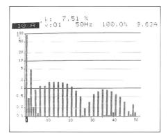
Bild 5 Spektrum der Oberschwingungsströme des SI-3000 bis zur 50. Harmonischen (2,5 kHz); eingespeiste Leistung  $P_{ac}$  = 2,3 kW.
