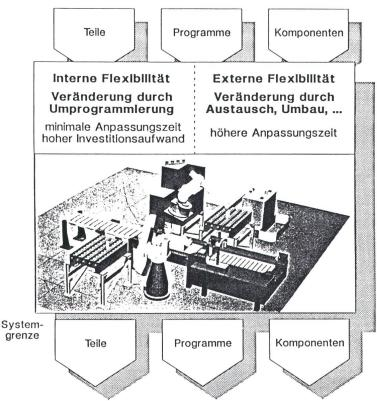
Bild 7 Systemstruktur eines rechnerintegrierten Arbeitsplatzes
