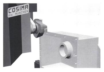
Bild 10 Simulation der NC-Bearbeitung
