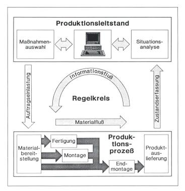
Bild 8 Regelung mehrstufiger Produktionsprozesse
