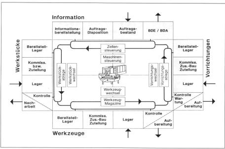
Bild 6 Die Fertigungszelle als Grundlage der Automatisierung
