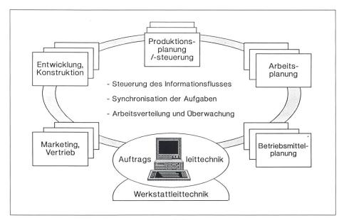
Bild 12 Auftragsleittechnik im Fertigungsvorfeld
