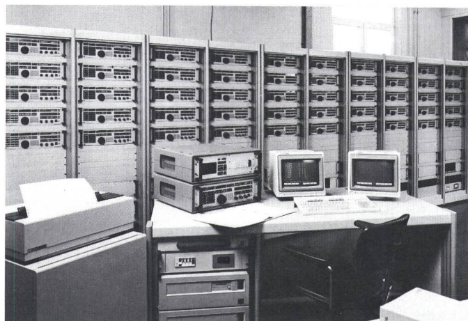
Bild 18 Empfängerbank mit 50 Empfängern von Telefunken Systemtechnik
