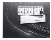
Der Multiplexer MUX 8824 von Câbles Cortaillod SA erlaubt gleichzeitig verschiedenartige Kanäle wie Telefonie, EDV-Daten RS282/V24, Fernwirksignale, Distanzschutz, Signalmeldungen, Fernmessungen über ein Multimode- oder Monomode-Glasfaserpaar zu übertragen.
