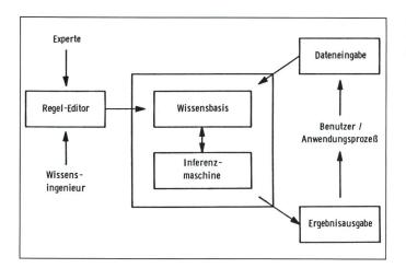
Bild 4 Grundstruktur eines Expertensystems
