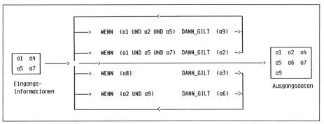
Bild 6 Wissensdarstellung in Form von Produktionsregeln
