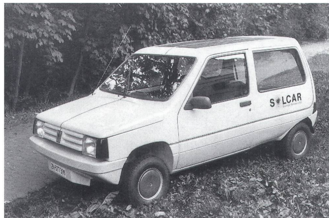
Neue Serie: Der Solcar 1 der Solarmobilgenossenschaft Filzbach für zwei Erwachsene und zwei Kinder oder zwei Erwachsene und 1400 Liter Stauraum, 9-kW-Asynchronantrieb auf die Vorderräder, Höchstgeschwindigkeit 70 km/h, Leergewicht 610 kg (davon ca. 1/3 Batterien), Zuladung 250 kg
