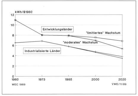
Bild 8 Entwicklung der Energieintensität 1960-2020
