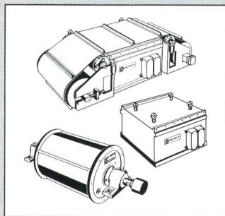
Rotierende Magnet-Bandtrommel: Sie ist am ganzen Umfang magnetisch und wird als Antriebs- oder Umlenkstrommel eines Förderbandes verwendet. Das im Fördergut enthaltene Eisen wird von ihr auf dem Förderband festgehalten, bis es auf der Unterseite durch das zurücklaufende Band wieder ausgetragen wird und in einen Behälter fällt.
