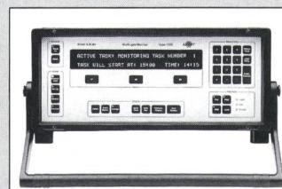
dient. Einmal eingestellt, führt er alle Messungen automatisch durch. Da er tragbar ist, eignet er sich für Kurzzeitmessungen, doch ermöglicht sein Datenspeicher ebensogut Langzeitüberwachungen. Bei Bedarf können Gasproben aus bis zu 50 m Entfernung zugeleitet werden.
