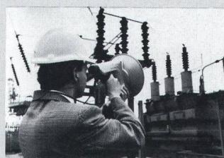
schalls erzeugt. Die eingebaute Optik ermöglicht die Anpeilung der gewünschten Stelle und unverzügliche Anzeige mittels LED in Stufen von 3 dB.
