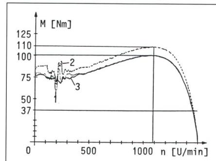
**Figur 3** Einfluss der Ständerwicklung auf die Drehmoment-Drehzahl-Kennlinie
