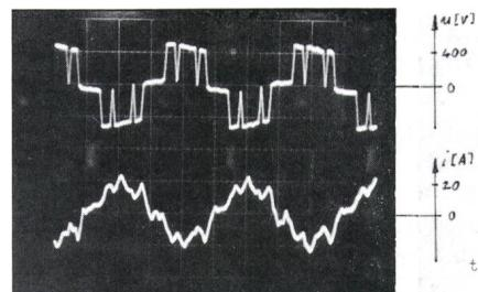
**Figur 9** Oszilloskopogramm von Spannung und Strom bei Umrichterbetrieb mit 50 Hz
