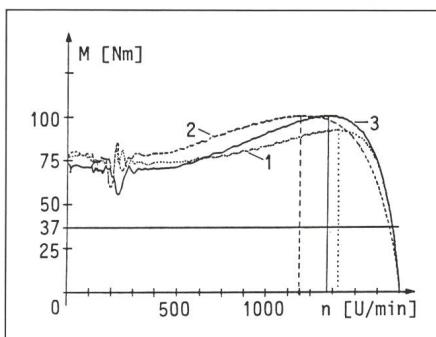
Figur 4 Einfluss der Läuferwicklung auf die Drehmoment-Drehzahl-Kennlinie
