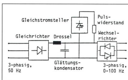
**Figur 7 Schaltbild des Frequenzumrichter-Leistungsteils**
