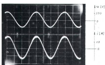
**Figur 6 Oszillogramm von Spannung und Strom bei Netzbetrieb**
