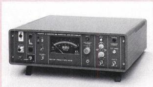
Überschreiten eines Schwellwertes zwischen 1 mA und 10 mA optische, akustische und elektrische Alarmkreise aktiviert, gleichzeitig kann die Prüfspannung selbsttätig abgeschaltet werden. Der durch den Prüfling fließende Leckstrom kann ebenfalls gemessen werden.
