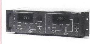
Durch die Steuerung und Programmierung mit IEC-Interface können diese Geräte im Labor, in der Fertigung und in der Qualitätskontrolle eingesetzt werden. Betriebssicherheit und Zuverlässigkeit werden durch Power-MOS-Fet's und die Überwachung wichtiger Parameter wie Temperatur, Leistung, Spannungsbereich und Polarität erzielt.
