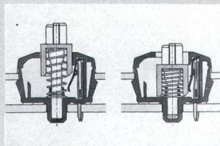
mit oder ohne Druckpunkt (Klick), sind auch mit integrierter Schalt- oder Leuchtdiode (verschiedene Farben) sowie als rastende Taste lieferbar.
