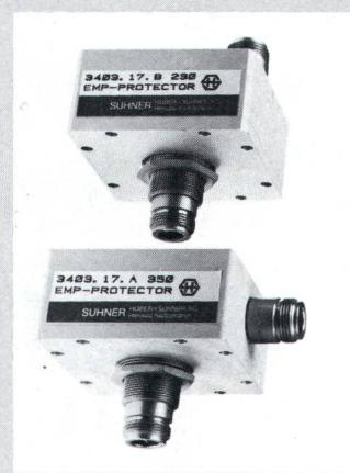
Schutz der handelsüblichen EMP-Ableiter nicht ausreicht. Die Schaltung basiert auf dem Gasableiter-Prinzip, wobei jedoch eine zweite Schutzstufe eingebaut wurde. Diese Ableiter werden in zwei mechanischen Versionen und mit zwei verschiedenen statischen Ansprechspannungen (230 V/350 V) geliefert. Dank der hohen Stromfestigkeit eignet sich dieses Bauteil auch als Blitzschutz. Die Standardprodukte sind mit N-Verbindern ausgerüstet. Andere Stecker sind auf Anfrage erhältlich.
