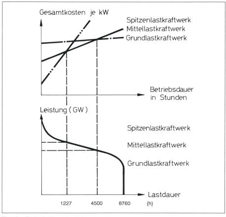
Figur 3 Optimale Einsatzbereiche von Kraftwerktypen
