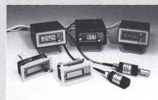
Die Geräte werden standardmäßig über Netzadapter oder netzunabhängig über einen eingebauten 9-V-Akkumulator betrieben. Besondere Merkmale der einzelnen Modelle sind die Umschalter für 6 verschiedene Druckeinheiten, Druckspitzenwertspeicherung, Grenzwertgeber mit Relaisausgängen usw. Die attraktiven Geräte sind als Tischmodell oder in Einbauausführung lieferbar.
