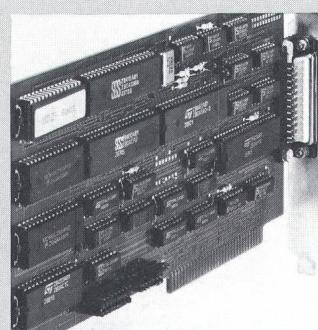
zessor ausgestattet und kann in alle XT/AT oder Kompatibile mit dem Betriebssystem MS-DOS eingesetzt werden. Dabei belegt jede PC-Karte EC 110 einen XT/AT-Steckplatz im PC. In einen PC können mehrere EC 110 eingesetzt werden. Bis zu sechs BDE-Terminals können über die multipunktfähige RS-485-Schnittstelle angeschlossen werden, die mit der ES-1-eigenen TAM-Prozedur auf HDLC-Basis (High Level Data Link Control) arbeitet. Der Zugriff auf
