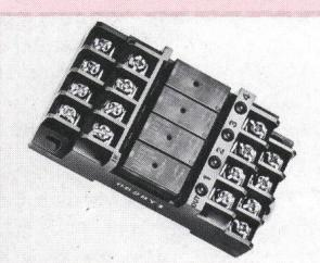
vorrangig für die Telekommunikation und den industriellen Einsatz. Die zwei Umschalter schalten eine Mindestlast von 10 mV/0,1 mA bis zu einer Nennlast von 0,5 A/125 VAC oder 1 A/30 VDC.
