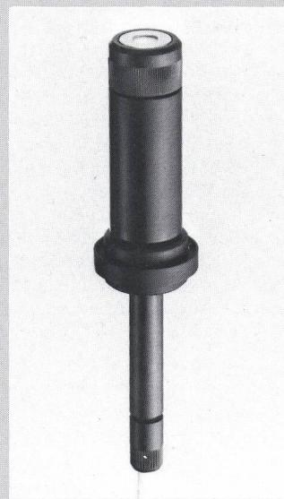
Hauser AG die neue membranbedeckte, amperometrische Messzelle Typ 971, die in einem weiten Bereich durchflussunabhängig arbeitet. Der Sensor 971 ist bei der Entkeimung von Trink-, Brauch- und Badewasser einsetzbar und erlaubt zusammen mit der Durchflussarmatur DFC eine einfache und zuverlässige Messung von Chlorkonzentrationen ab 0,05 mg/l in einem Temperaturbereich von 10-45 Grad Celsius. Die Messzelle verfügt über eine kurze Bereitschaftszeit von 10-30 Minuten.
