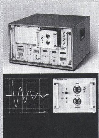
Test-Systems erlaubt EMV-Prüfungen mit gedämpft oszillierenden Schwingungen auf Versorgungs-, Signal- und Steuerleitungen und daran angeschlossenen Prüflingen. Untersuchungen von GE, IEEE & IEC haben ergeben, dass im Innern von Gebäuden die unipolaren, doppexpotentziellen Pulse der atmosphärischen Entladungen in oszillierende Transienten umgeformt werden.
