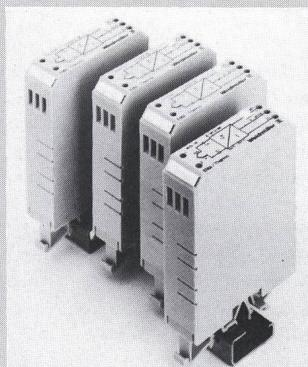
bis 220 mA zu übersetzen. Der EMA-Thermo-Baustein erkennt einen Thermoleitungsbruch und zeigt ihn über LED an. Die Schraubanschlüsse des Wandlers sind kaltstellenkompensiert. Ein EPROM ermöglicht einen Linearisierungsfehler kleiner als 0,1%.
