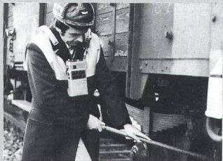
z. B. mit einer Sprach-Verschlüsselung für Polizei und andere Sicherheitsdienste oder mit einem Frequenzsynthesizer für bis zu 200 wählbare Kanäle oder mit Speziallakku für den Bahnbetrieb. Ein umfassendes Zubehörangebot macht das kompakte, für den rauen Alltagsbetrieb gebaute Handfunkgerät universell einsetzbar, z. B. auch für den Fahrzeugfunk.
