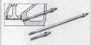
Der Drucksensor Typ 6051A kann abhängig von der Messaufgabe wahlweise frontdichtend oder schulterdichtend montiert werden.
