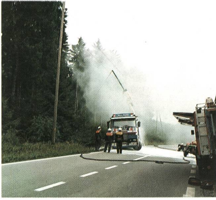
Figur 3 Ausgefahrener Lastwagenkranarm berührt 16-kV-Leitung: Todesfall und Pneumbrand
