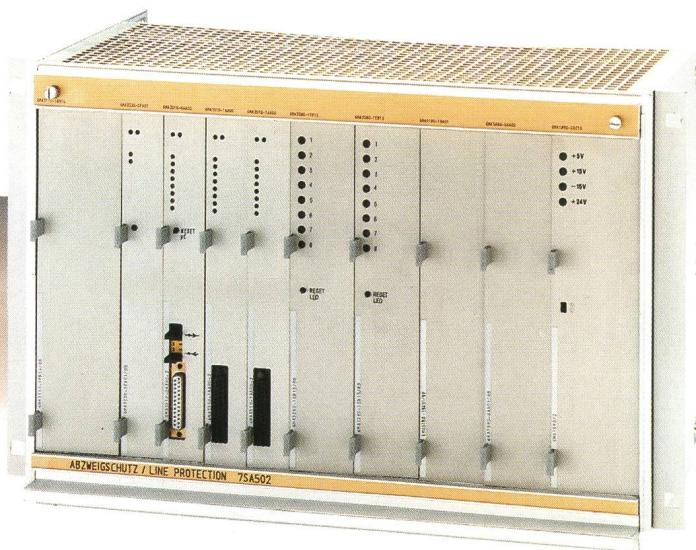
**Der mikroprozessorgeführte Selektivschutz 7S** besteht aus Stationsschutz und Abzweigschutz. Der Stationsschutz mit dezentralen und zentralen Intelligenzen sorgt für Sammelschienen- und Schaltver-sagerschutz. Der Abzweigsschutz verfügt neben der Basisfunktion Distanzschutz über die Zusatzfunktio-nen Wiedereinschalten, Fehlerortung, Erfassen/Spei-chern von Kurzschlussdaten und Betriebsmessung.
